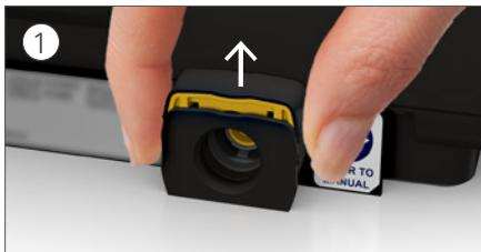
L'appareil étant posé sur une surface stable et de niveau, saisissez le clip de fixation à l'arrière de l'appareil et tirez vers le haut pour ouvrir. Remarque : Le clip de fixation est montré dans la position ouverte.
