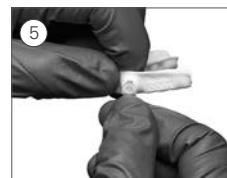
1. Halten Sie die Schiene so, dass sich die Verbindungsstege auf einer Höhe mit der flügelförmigen Aussparung auf der Schiene befinden.
