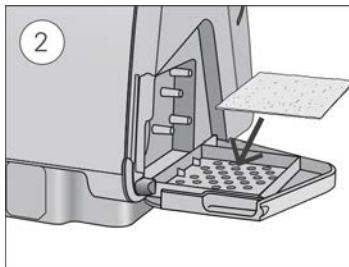
1. Ανοίξτε το κάλυμμα του φίλτρου αέρα και αφαιρέστε το παλιό φίλτρο αέρα.
