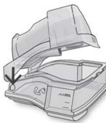
1. Inserte un lateral de la tapa en el orificio pivotante de la base.
