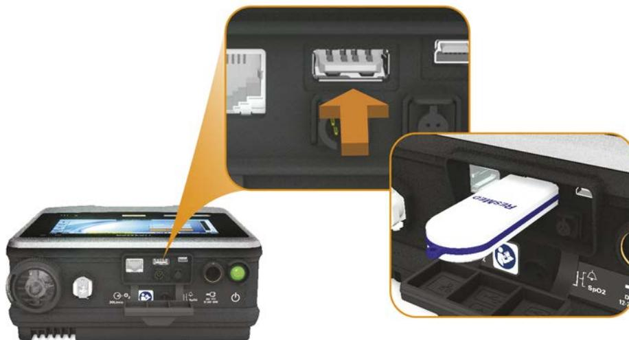
Per rimuovere la chiave USB, basta estrarla dal connettore USB al termine del trasferimento. Se in quel momento è in corso il trasferimento di dati, un messaggio nella barra delle informazioni avverte che il trasferimento non è riuscito.
