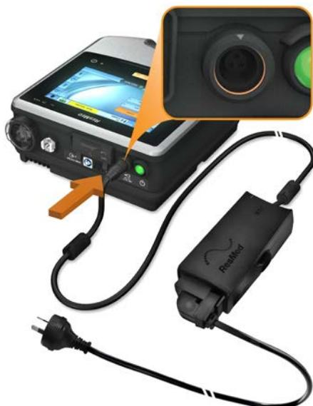
**Σημείωση:** Το καλώδιο ρεύματος είναι εξοπλισμένο με σύνδεσμο ασφάλισης ώθησης-έλξης. Για αφαίρεση, πιάστε το περιβλήμα του καλωδίου ρεύματος και, με ήπιες κινήσεις, τραβήξτε τον σύνδεσμο από τη συσκευή. Μην περιστρέψετε το εξωτερικό του περιβλήμα και μην τραβάτε το καλώδιο.
