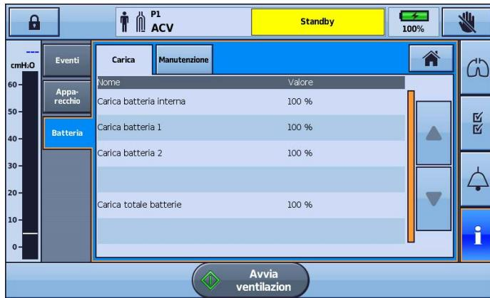
Controllare con regolarità il livello di carica della batteria interna e di ciascuna batteria esterna collegata. Si consiglia di sostituire le batterie dopo 400 cicli di carica.
