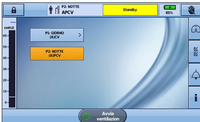
**Nota** - Per passare a un programma con un tipo di circuito diverso, è necessario arrestare la ventilazione. Dopo aver cambiato circuito e programma, è possibile riprendere la ventilazione.
