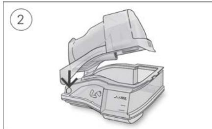
1. Umieścić jedną stronę pokrywy w otworze przegubowym podstawy.
