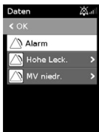
Werden gleichzeitig mehrere Alarme ausgelöst, wird die aktuellste Alarmmeldung auf dem Bildschirm angezeigt und alle anderen ausgelösten Alarme werden in der Alarmliste aufgeführt.
