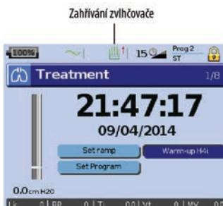
Zkontrolujte, zda funkce zahřívání je zobrazena na obrazovce Treatment (léčba). Spusťte funkci zahřívání. Zkontrolujte, zda symbol zahřívání zvlhčovače je zobrazen na horní části obrazovky.
