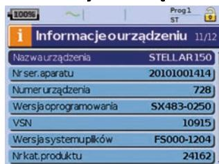
Na tym ekranie wyświetlany jest numer seryjny urządzenia, numer urządzenia, wersja oprogramowania i wersje innych komponentów. O dane z tego ekranu może poprosić technik w celach serwisowych lub w ramach rozwiązywania problemów.
