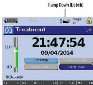
V případě potíží s vypínáním ventilace můžete použít funkci Ramp Down (doběh). Tato funkce v průběhu pěti minut sníží léčebný tlak na Start EPAP/PEEP (počáteční EPAP/PEEP). Po pěti minutách se léčba ukončí. Klinický pracovník může funkci Ramp Down (doběh) aktivovat v nabídce Options (možnosti).
