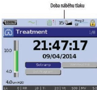
Náběhová doba (ramp time) je funkce, kterou může v přístroji aktivovat váš lékař, který může nastavit maximální náběhovou dobu. Náběhová doba je doba, během níž se přetlak používáný v průběhu léčby postupně zvyšuje od nízkého až k terapeutickému přetlaku používanému při léčbě. Při postupném zvyšování tlaku je používání přístroje pro pacienta příjemnější. Viz nabídka Setup (nastavení): Options (možnosti) (viz str. 16).
